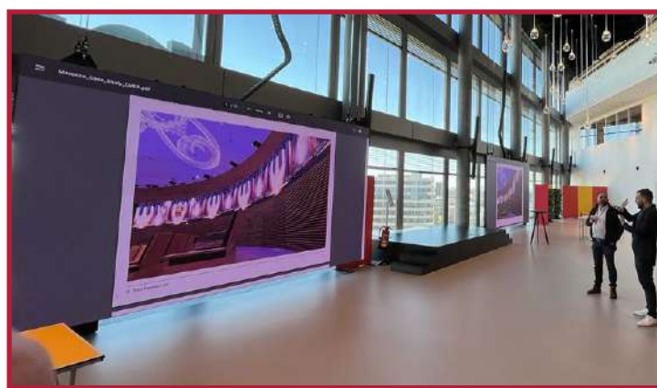
dvLED-Montagesystem der SEAMLESS Bespoke-Serie. Diese einzigartige Installation besteht aus zwei schwebenden dvLED-Wänden im Format 4,8 x 2,7.
