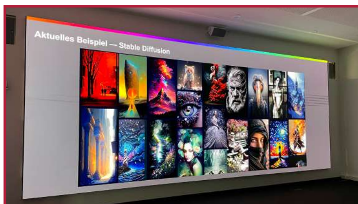
Boden-Decke dvLED-Montagesystem der SEAMLESS Kitted+ Serie, eingebaut in Gipskartonplatten, um es schwebend erscheinen zu lassen, installiert an der Universität Konstanz, Deutschland.
